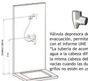
Válvula depresora de vaciado y evacuación, permite cumplir con el informe UNE 100030IN "La tubería de acometida de agua a la cabeza difusora y a la misma cabeza deben quedar vacías cuando las duchas o grifos no estén en uso"
