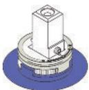
Limitación de temperatura máxima prerregulada por el anillo tope situado bajo la maneta. Para retirar la maneta, utilizar una llave Allen de 2,5 mm.
